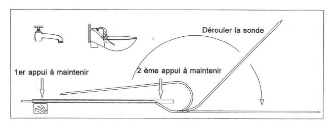
Pour dérouler la sonde en tube recuit et ne pas forcer sur la soudure, placer la colonne sur le sol comme indiqué sur le schéma ci-dessus.
